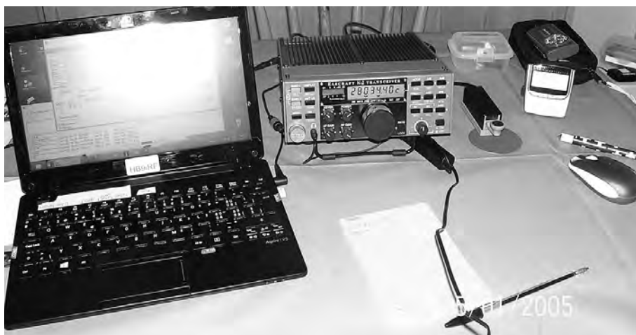
Die Station mit Rechner, Funkgerät, zusätzlicher Handtaste und Uhr.
