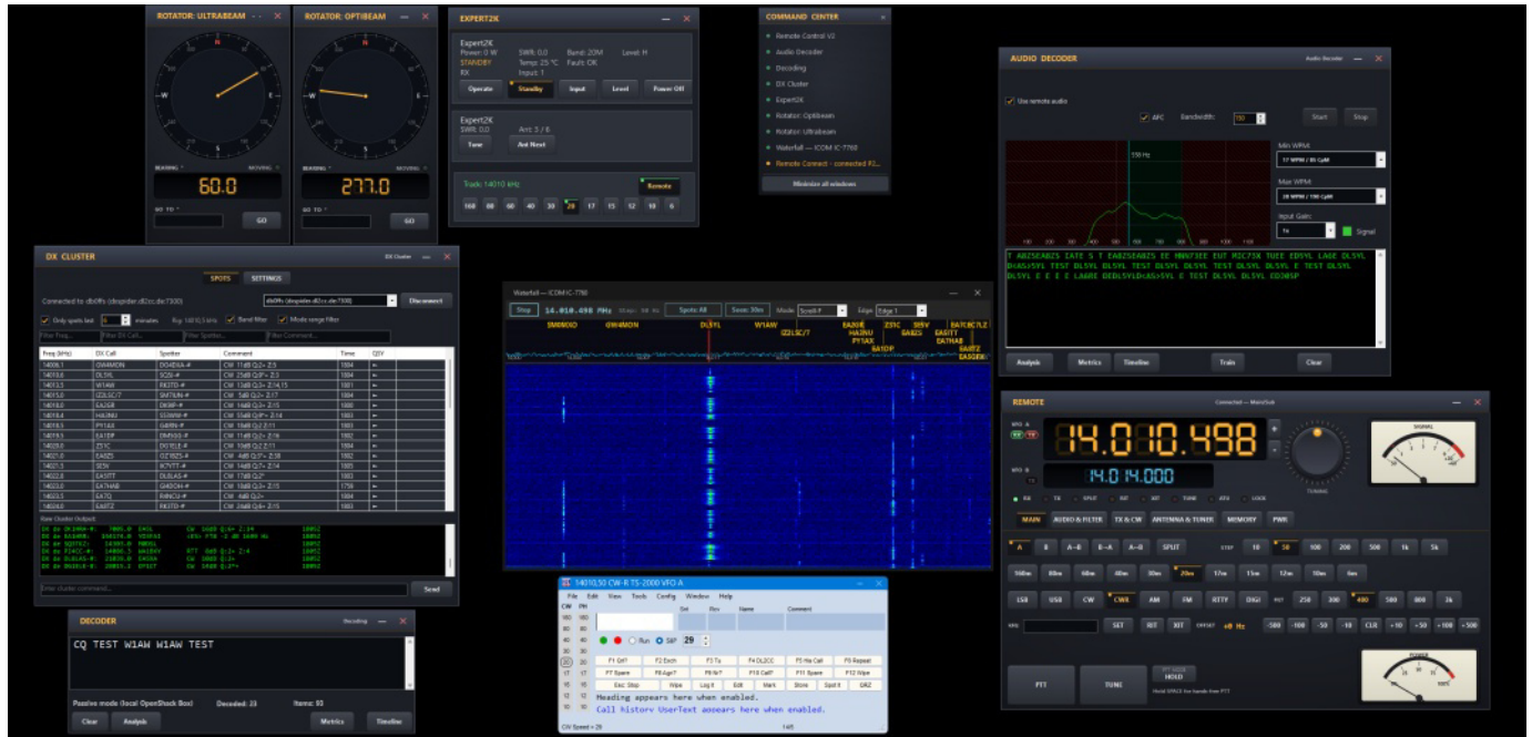
Bild 6: OpenShack Remote bündelt Funksteuerung, Audio, CW und weitere Stationsfunktionen.
