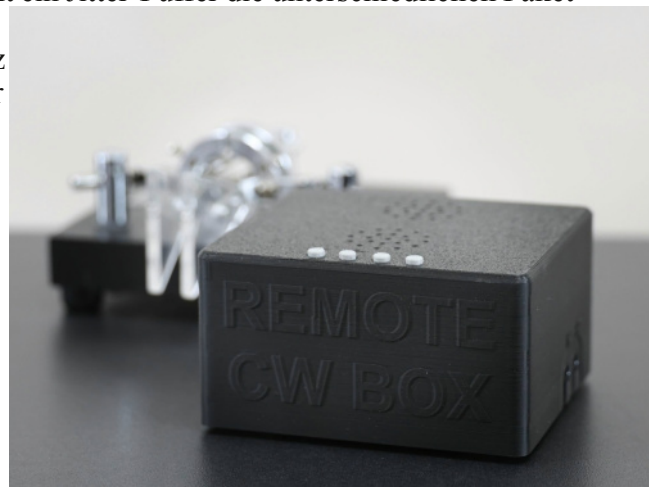
Bild 5a: Die OpenShack Box verbindet Handtaste oder Paddle mit Training, Funkgerät und Remote-Betrieb.
